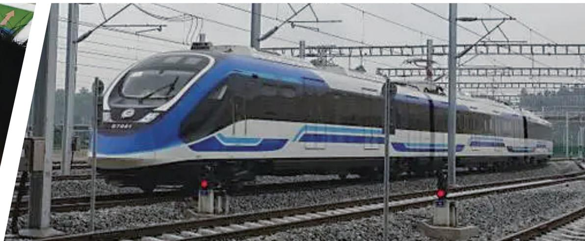
璧铜线开始热滑试验
